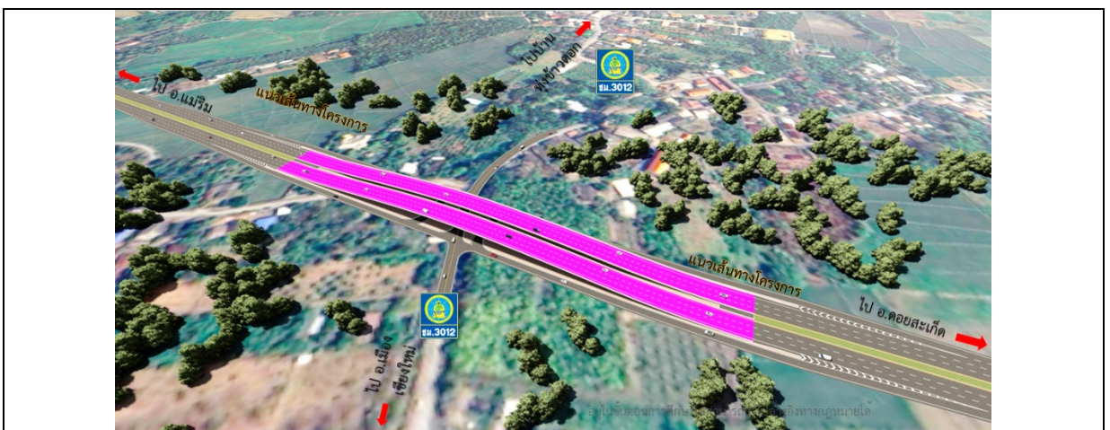
รูปที่ 7-4 รูปแบบทางแยกต่างระดับ ถนนโครงการตัดกับทางหลวงชนบท หมายเลข ชม.3012
