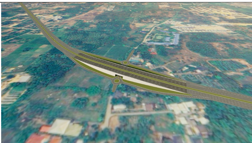
รูปที่ 8-4 ทางลอดสำหรับรถขนาดเล็ก (สูงไม่เกิน 2.5 เมตร)
